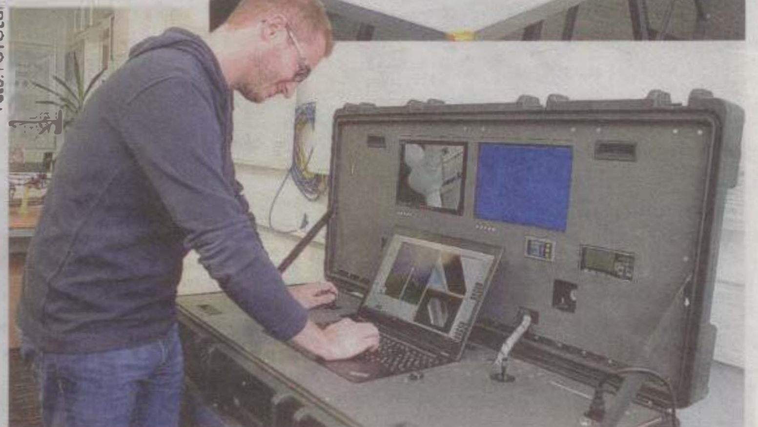
Ein Pilot und ein Co-Pilot steuern die Hubschrauber-Drohne von Aero Enterprise (o.) von der Bodenstation (u.) aus.
