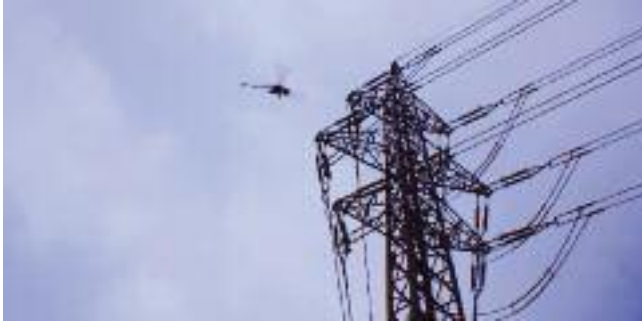
Die Drohne inspiziert und dokumentiert Schäden in der Vertikalen. Das können neben Windkraftanlagen z.B. auch Strommasten oder Industrieanlagen sein.
