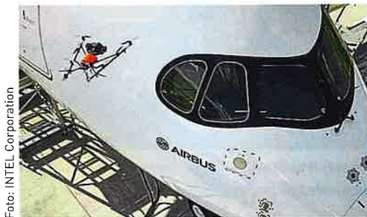
Intel & Airbus: Drohnen-Inspektion von Flugzeugen
