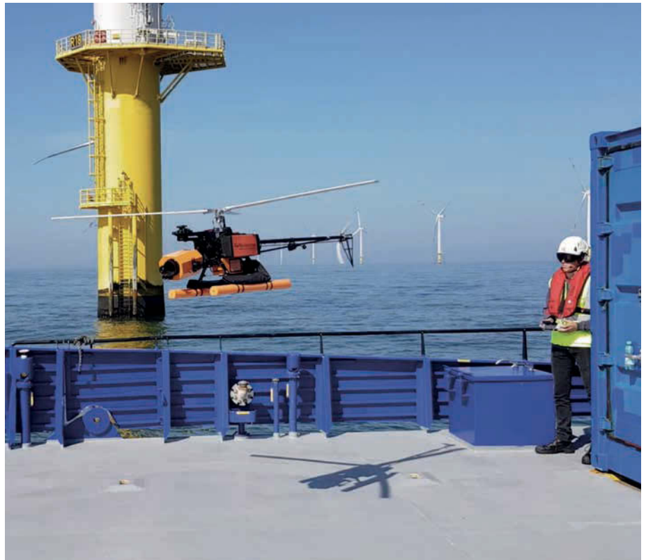
Die Hubschrauber-Drohne AERO-SensorCopter hat erstmals erfolgreich Offshore-Windenergieanlagen in der Nordsee inspiziert
